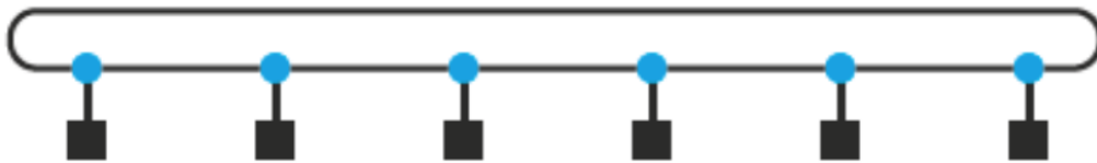
Figuur 10: Schematische weergave van een ring netwerk topologie met processor knooppunten als zwarte vierkanten en netwerk switches als blauwe cirkels
